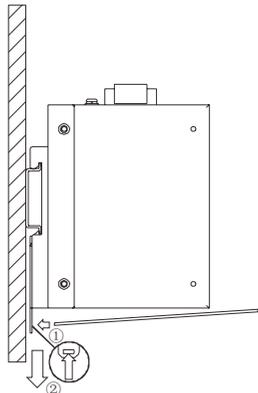
第三步：导轨卡扣与DIN35mm导轨解锁后，按装配的反顺序，先把产品下方往后轻抬脱离导轨后再往上抬起即完成拆卸。
