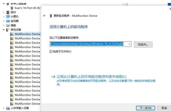
这里安装好一个端口后可以选择自动搜索以快速完成安装
